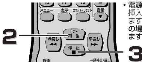
• 電源OFFの状態ビデオテープを挿入すると、自動的に電源が入ります。(ツメが折れているテープの場合は、自動的に再生が始まります。)
