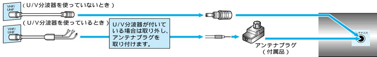
壁にアンテナ端子がある場合はアンテナ線を取りはずしアンテナ～ビデオ間に付属の同軸ケーブルを使用します。取りはずしたアンテナ線はビデオ～テレビ間に接続してください。
